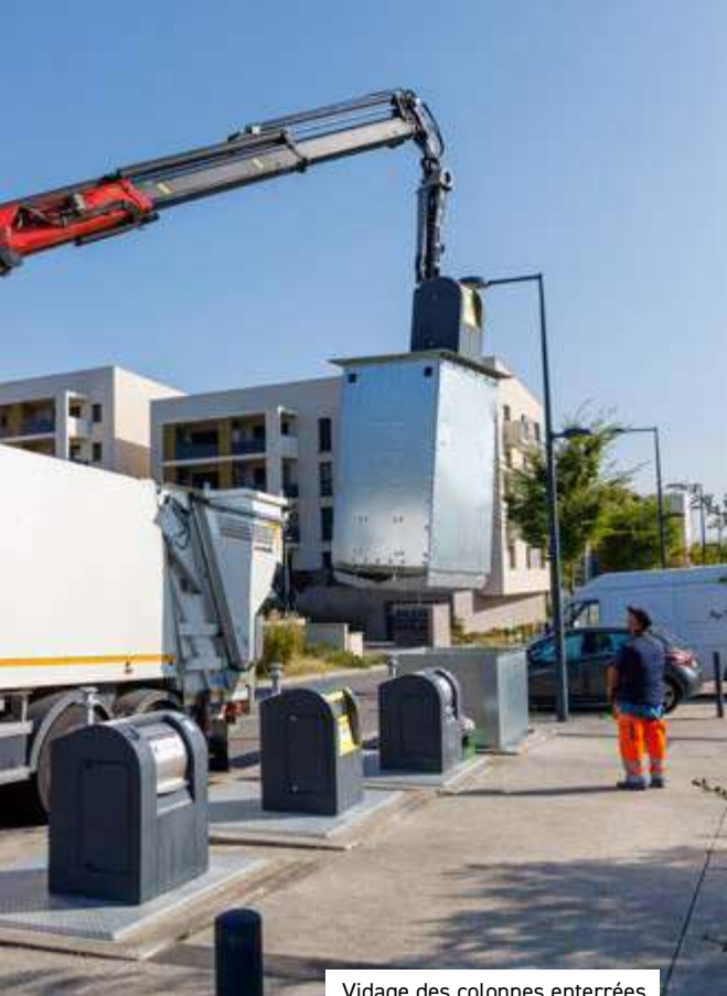
Vidage des colonnes enterrées
